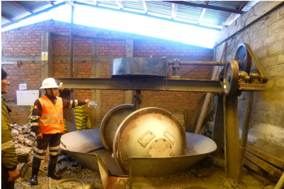
Fotografía N° 1.11 Trapiche utilizado en el beneficio de minerales mediante la amalgamación del oro – Mina la Rinconada
