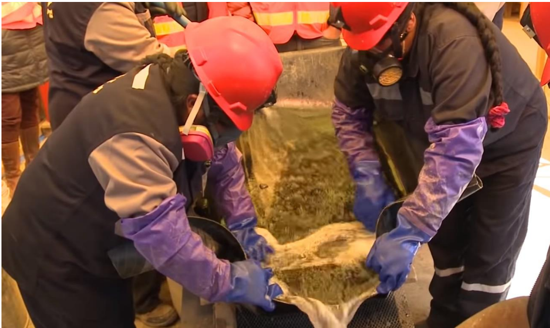
Fotografía N° 1.20 Proceso de Amalgamación de las arenillas negras con mercurio, que fueron recogidas de las alfombras después del lavado a presión en los shutes.
