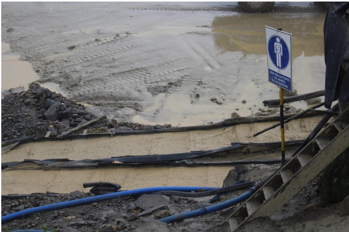
Fotografía N° 1.18 Proceso de lavado de las gravas en alfombras para capturar las partículas de oro – Ananea.
