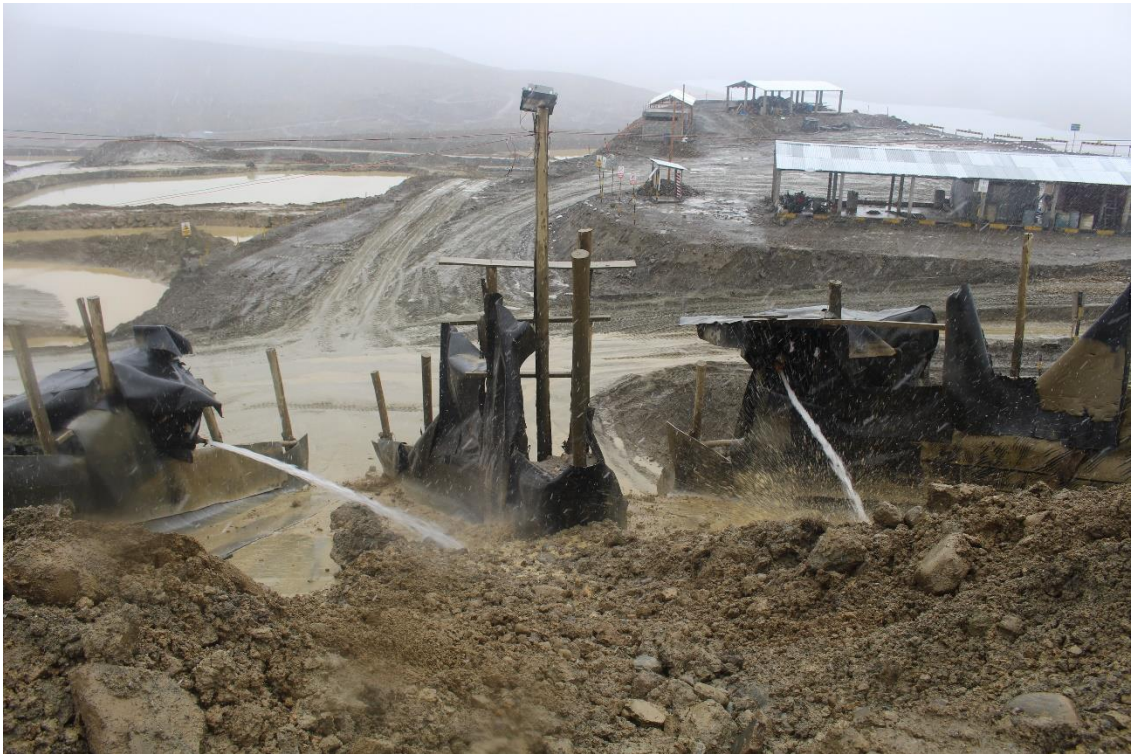
Fotografía N° 1.15 Proceso de lavado de las gravas auríferas en los shutes con agua a presión – Ananea.
