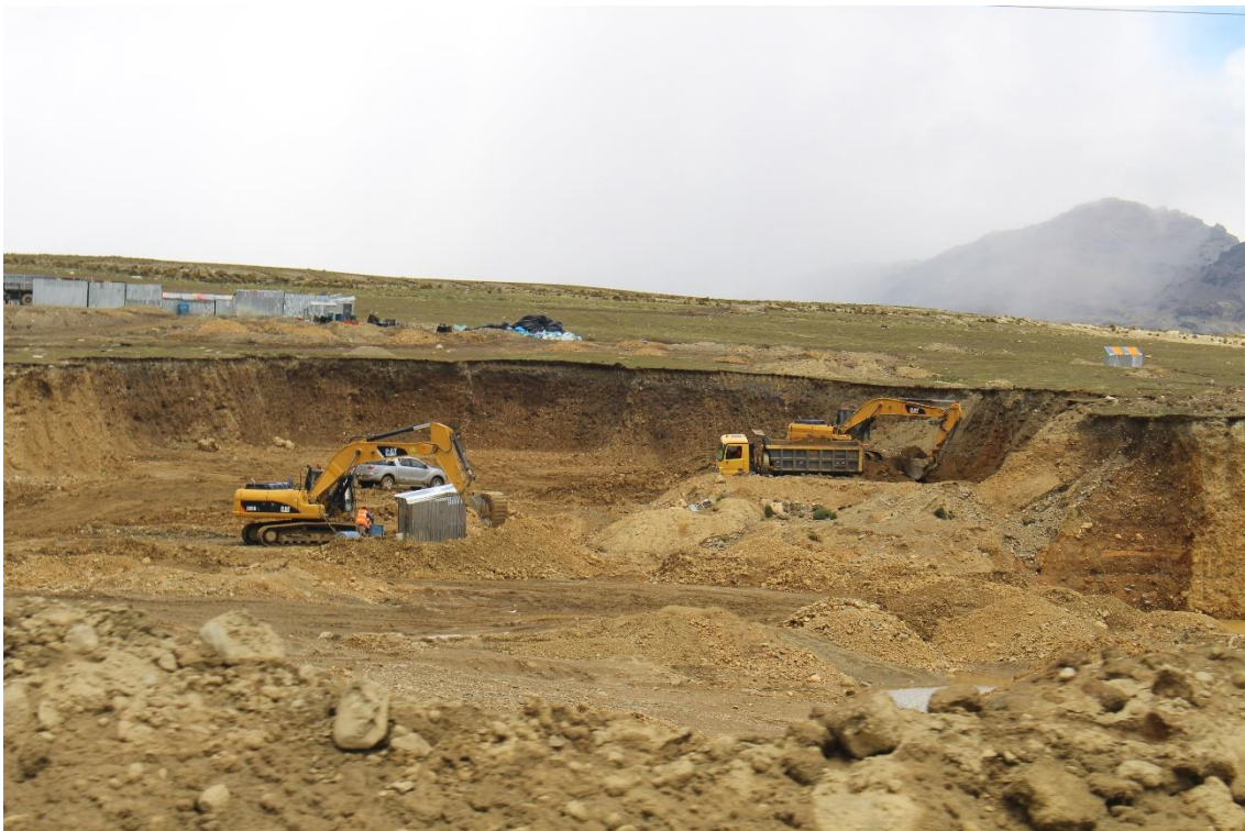
Fotografía N° 1.14 Explotación de morrenas auríferas en la zona de Ananea, altamente mecanizada con volquetes, cargadores frontales y palas.
