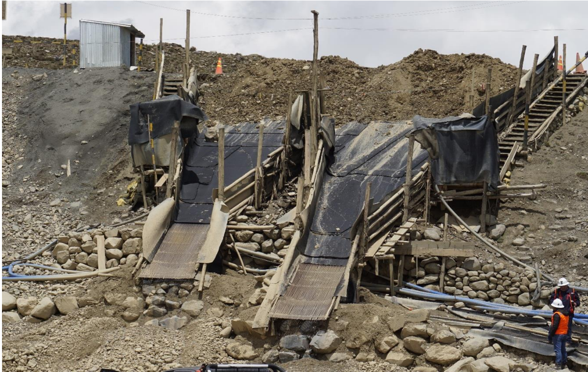
Figura N° 3.12: Transporte y Procesamiento de Material Morrénico Aurífero – Sector Ananea
