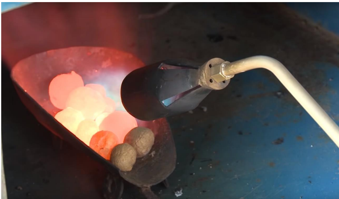
Fotografía N° 1.21 Proceso de quemado en retorta después del proceso de amalgamado con mercurio - Ananea
