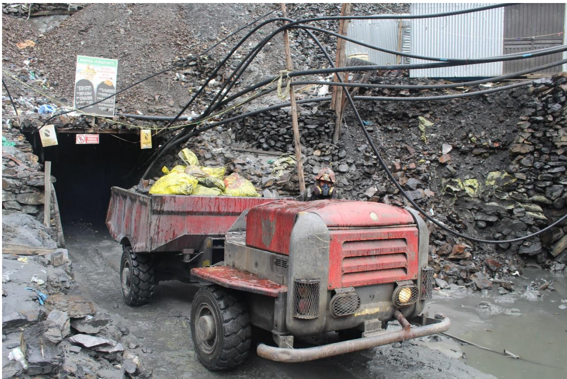
Fotografía N° 1.6 Dumper transportando mineral del interior mina - Rinconada
