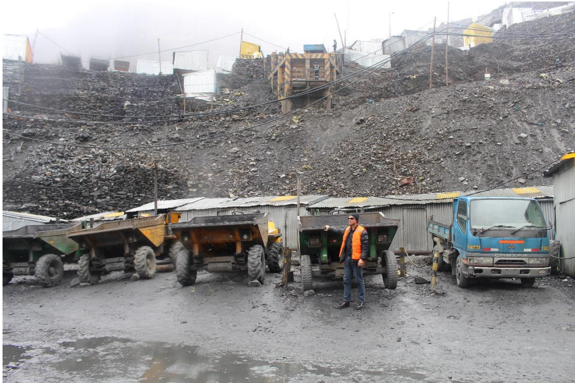
Fotografía N° 1.5 Equipos Dumper y Canter utilizados para el acarreo de mineral - Rinconada
