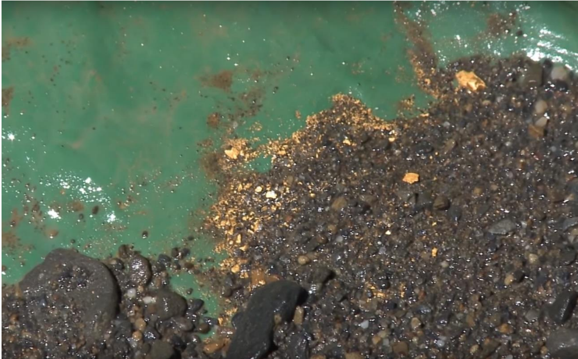
Fotografía N° 1.19 Concentración de partículas de oro en las alfombras después del lavado en las canaletas de los shutes – Ananea.
